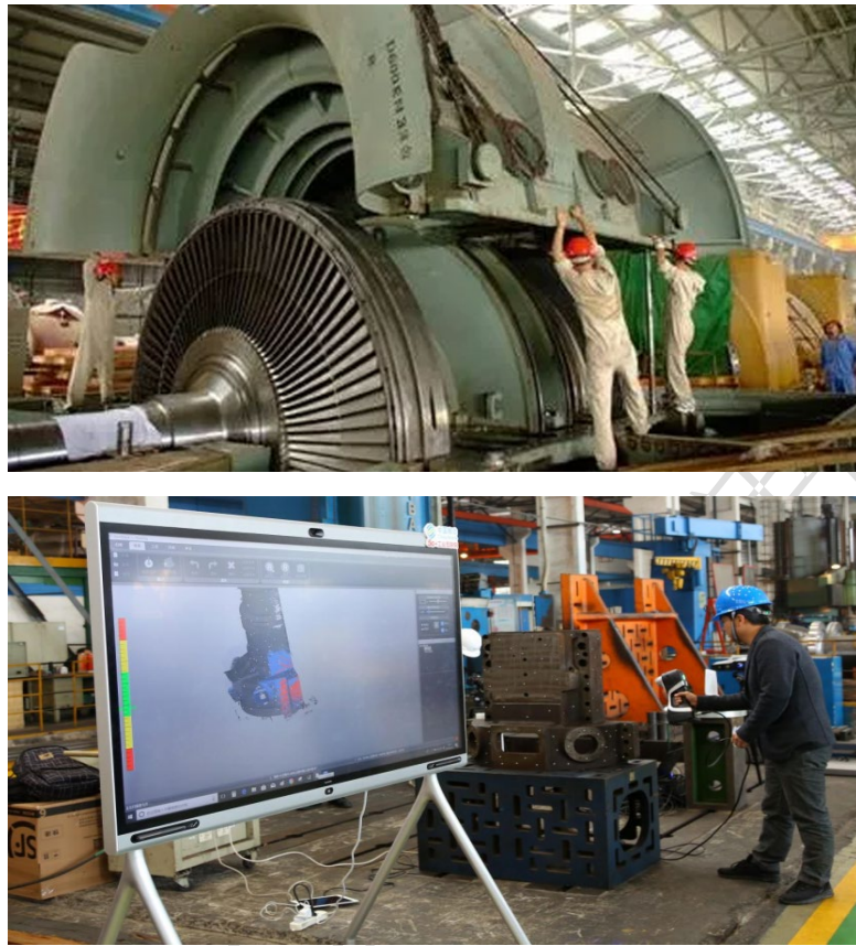
图 5-1 杭汽轮集团 5G 三维扫描建模检测系统
