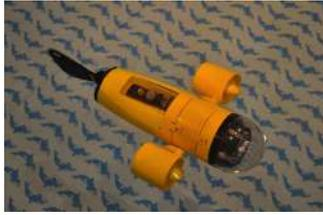
图 4-30 仿生尾鳍与螺旋桨混合推进水下机器人
